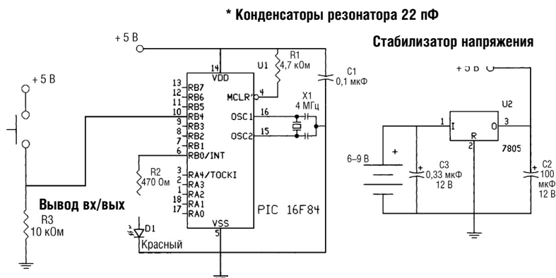
■ Рис. 6.22. Схема ключа высокого уровня
