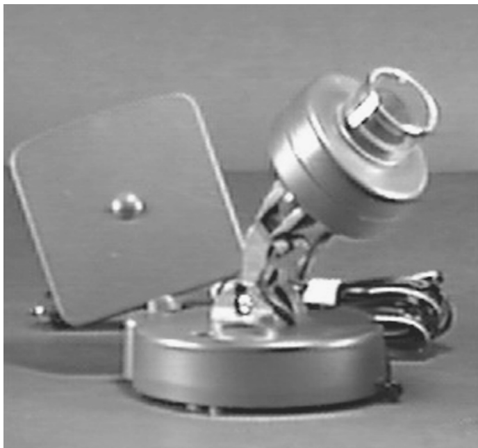
■ Рис. 9.4. Цветная видеокамера со звуковым сопровождением и передатчик диапазона 2,4 ГГц
