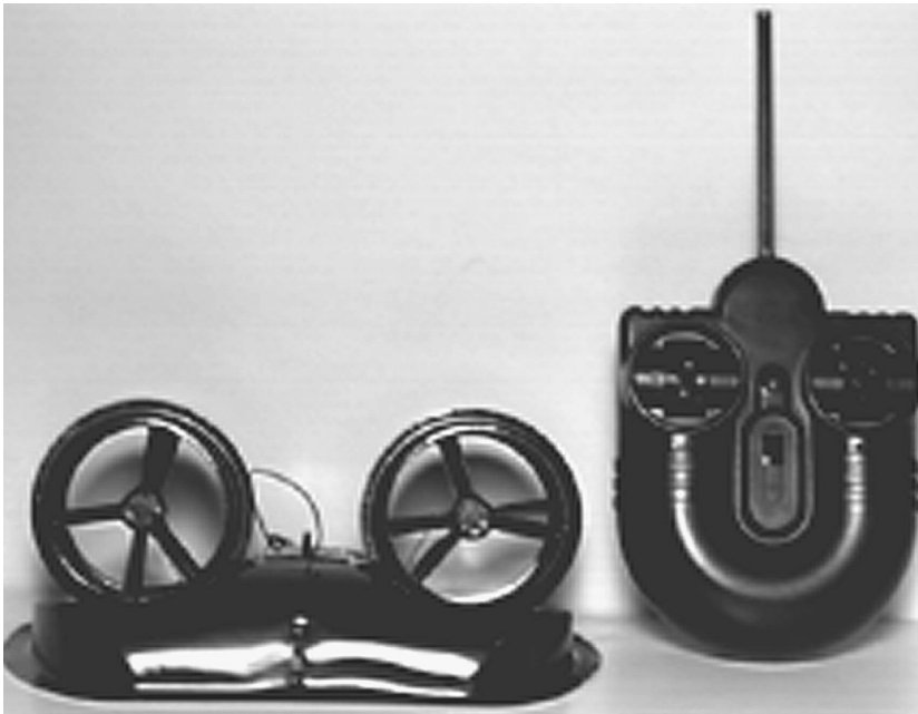
■ Рис. 14.5. Легкая система радиуправления для дирижабля
