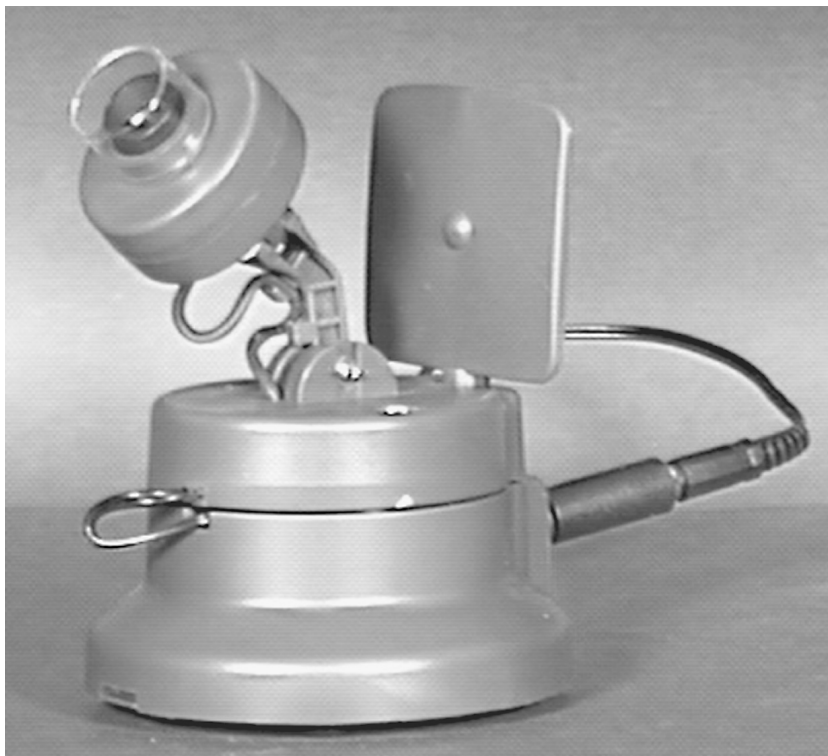
■ Рис. 9.7. Цветная видеокамера и батарейный отсек в сборе, готовые к размещению на модели автомобиля
