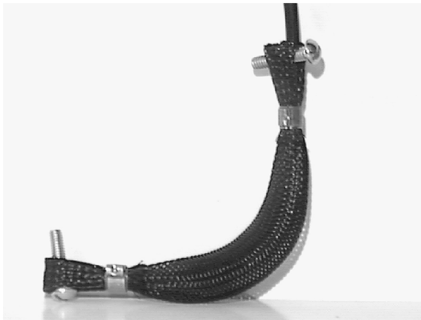
■ Рис. 16.5. Винт проходит через одну из петель воздушной мышцы
