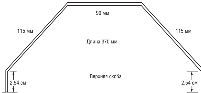
■ Рис. 8.8. Боковой вид верхней скобы, изготовленной из алюминиевой полосы 3×12×370 мм
