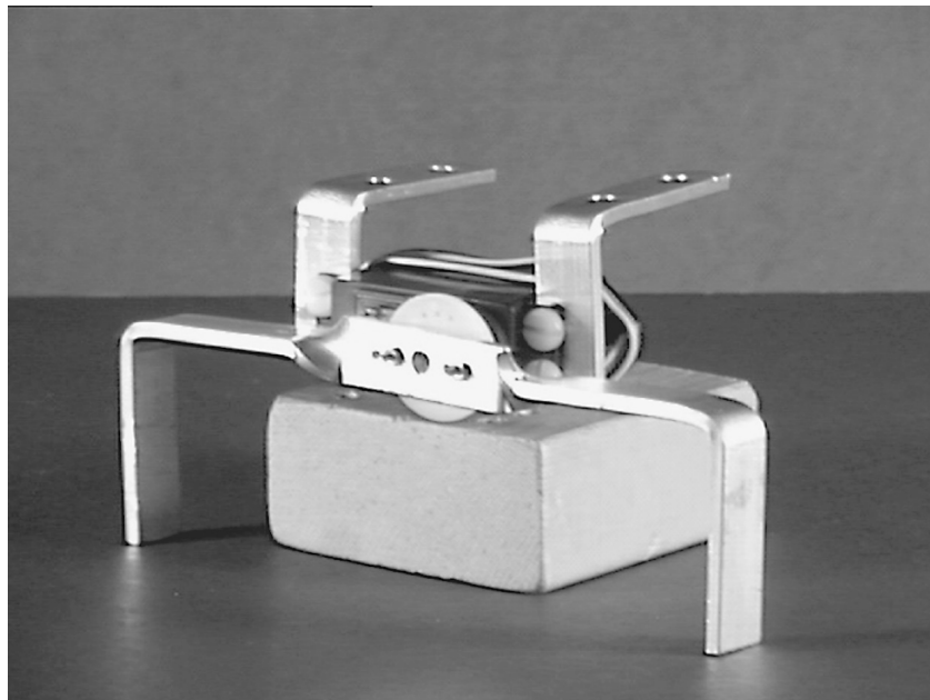
■ Рис. 11.14. Центральный мотор в сборе с крепежными скобами и средними ногами
