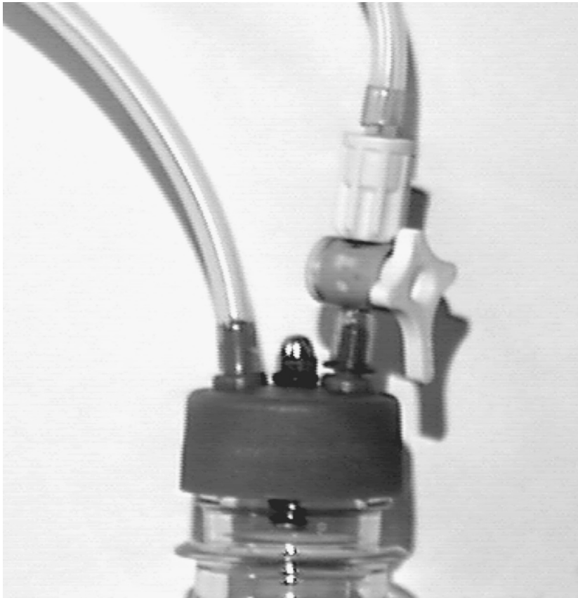
■ Рис. 16.11. Использование прозрачной медицинской трубки со стандартными переходниками
