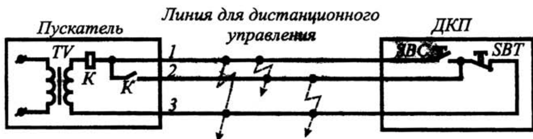
Рис.10.2. Схема управления пускателя без защиты от потери управляемости
