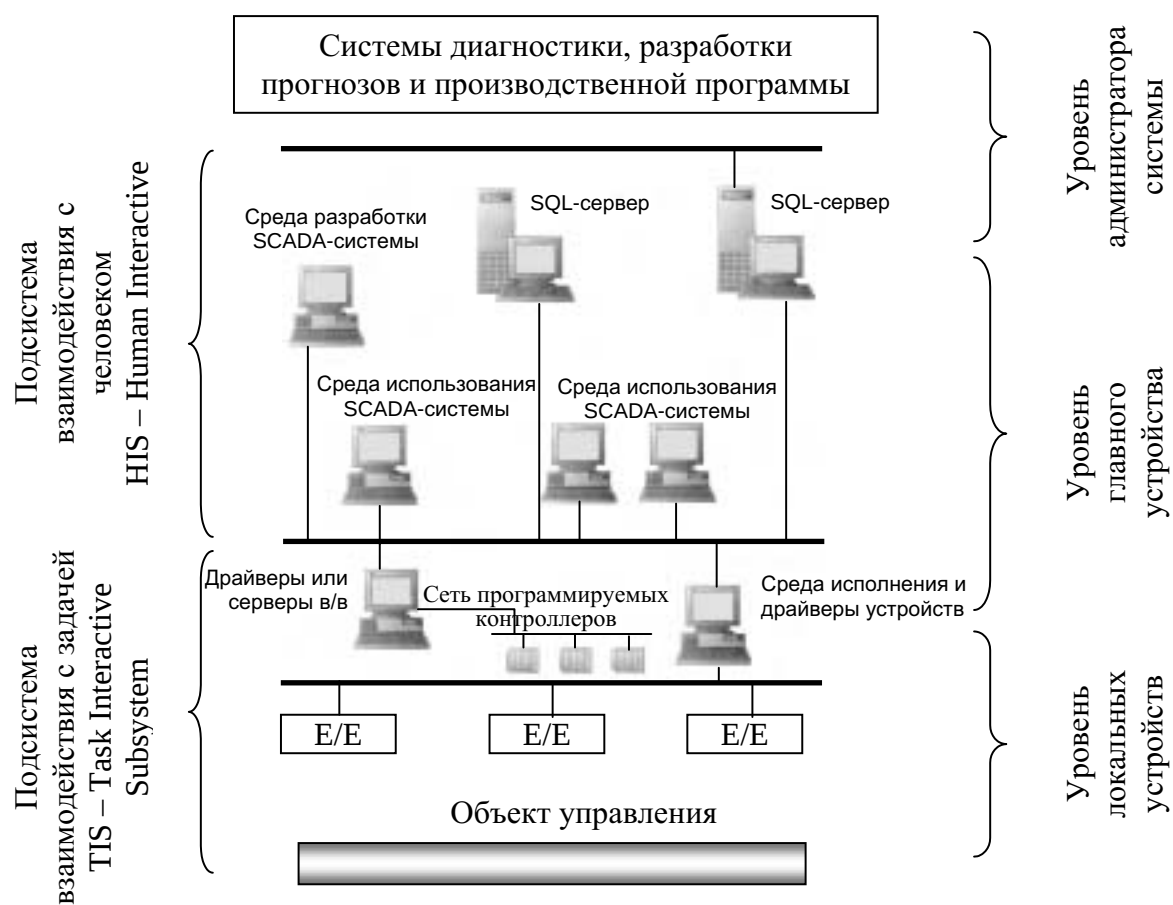
Рисунок 32 - Схема интеграции SCADA-приложений в комплексные системы управления
