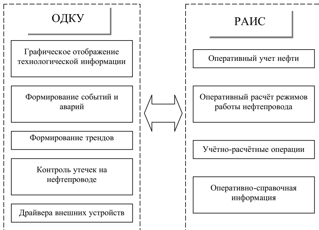
Рисунок 19 – Функциональная структура СДКУ
