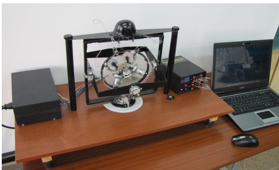
Рисунок 6.8 – Макет микроспутника с электромаховичными приводами пирамидальной структуры
