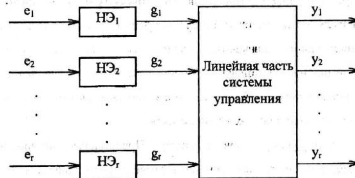
Рис.2.7. Обобщенная функциональная схема разомкнутой нелинейной системы: НЭ i , i = \overline{1, r} – существенно нелинейные статические элементы
