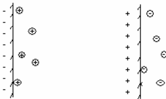
Рисунок 3.2.1 – Схема строения двойного электрического слоя.
