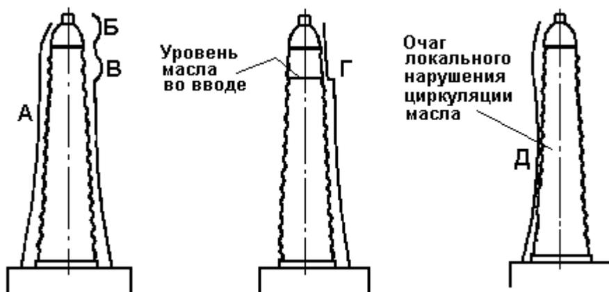
Рис. 11.2. Характер распределения температуры по высоте маслонаполненного ввода:
