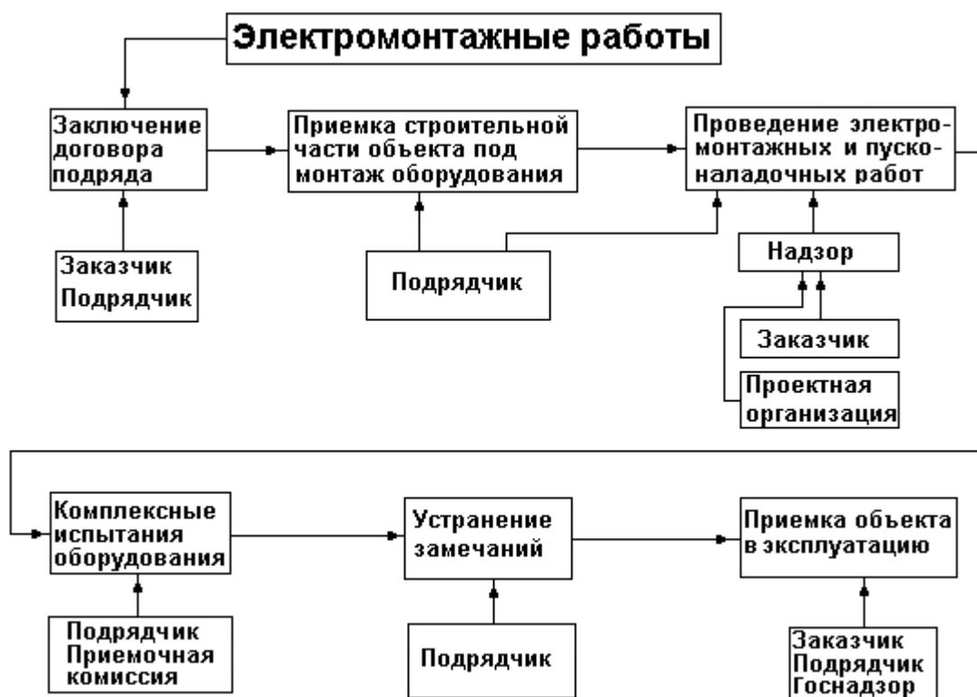
Рис. 1.1. Основные этапы проведения электромонтажных работ
