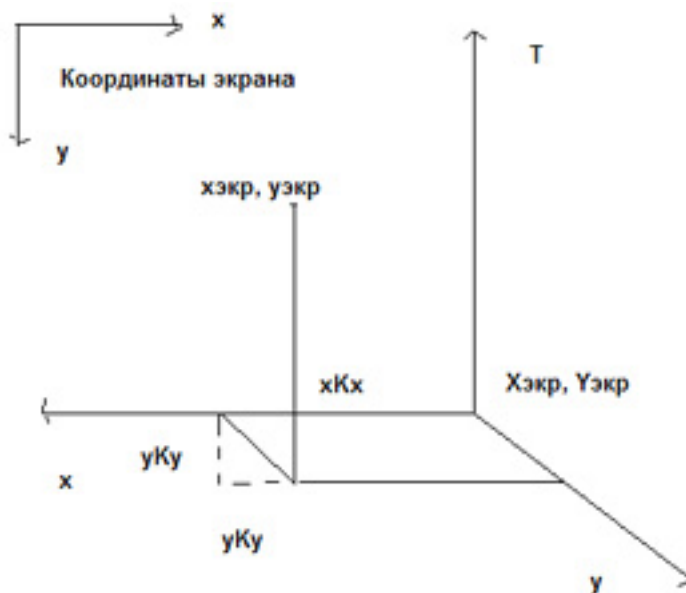
Рис. 6. Положение координат трехмерного пространства на плоском экране
