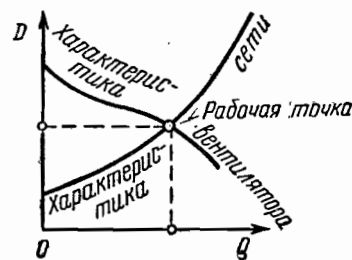
Рис. 105. Наложение характеристики сети на характеристику вентилятора
