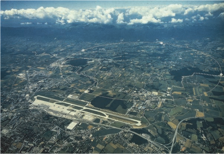
Рис. 1.1. Панорама ЦЕРНа (вид на запад). На снимке обозначено положение тоннелей LHC (длина 27 км) и SPS (длина 7 км). Крестиками отмечена франко-швейцарская граница (снизу Швейцария). Предполагается, что на LHC удастся обнаружить бозон Хиггса. [©CERN http://cdsweb.cern.ch/record/39027 ]
