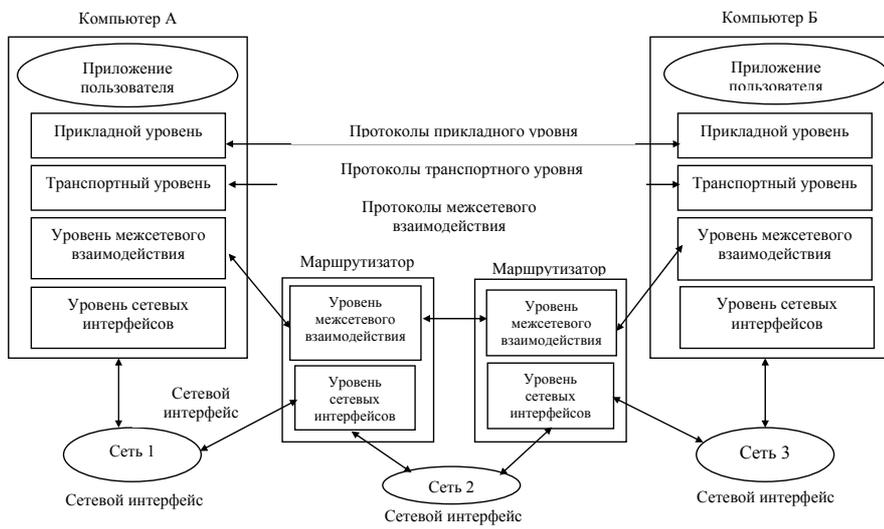
Рис. 5.6. Сетезависимые и сетезависимые уровни стека TCP/IP
