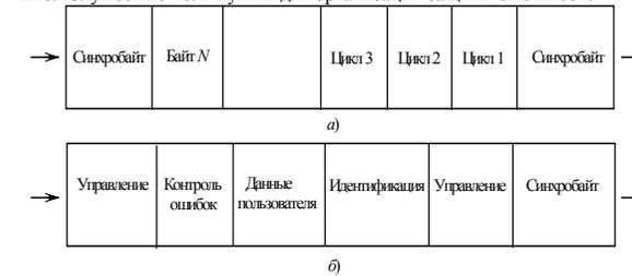
Рис. 2.6. Синхронный формат (а) и типичная синхронная передача (б)
