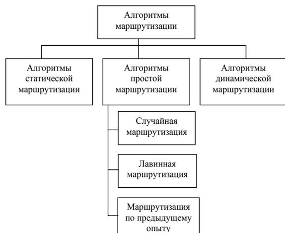
Рис. 5.2. Классификация алгоритмов маршрутизации
