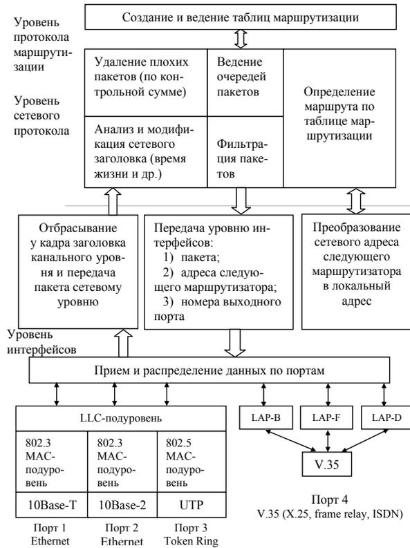
Рис. 5.3. Функциональная модель маршрутизатора
