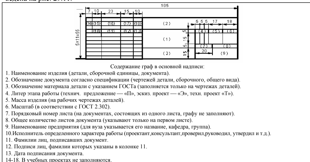
Рис. 29.8. Содержание граф и размеры основной надписи чертежа
