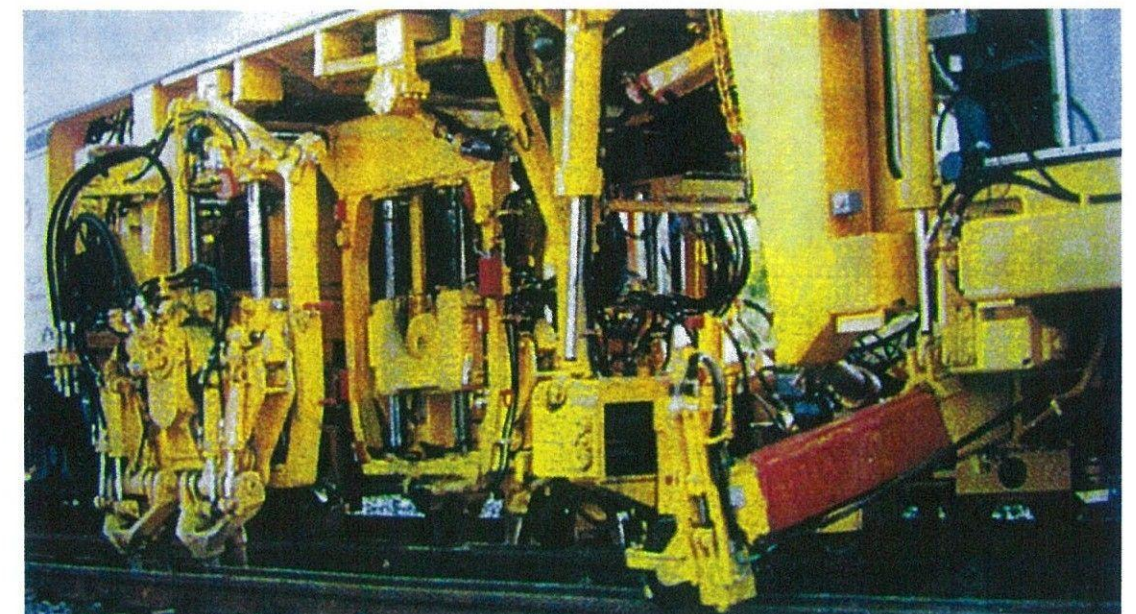
Подбивочные блоки и ПРУ машины «Unimat Compact 08-475-4S»
