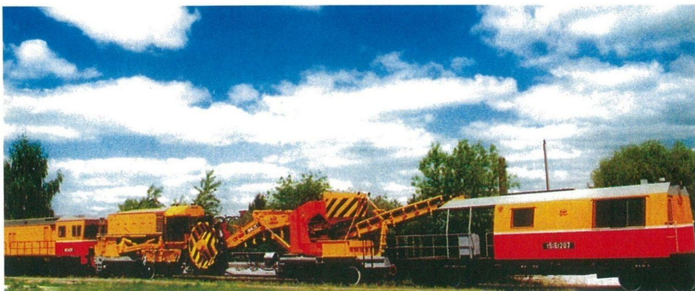
Машина для ремонта земляного полотна СЗП-600
