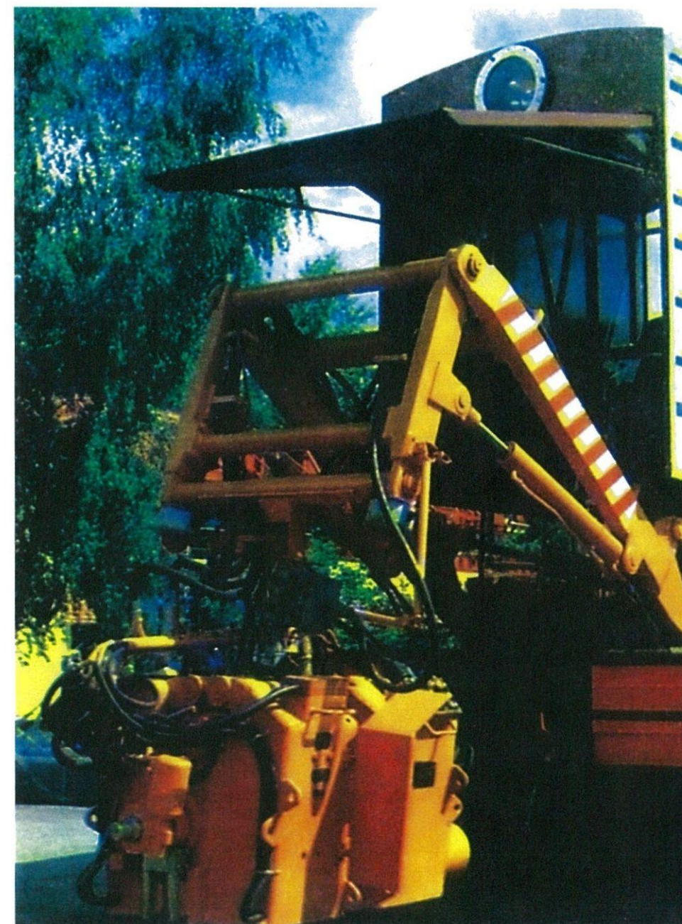
Сварочная головка и манипулятор рельсосварочной машины ПРСМ-4
