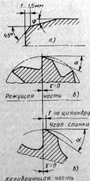
Основная работа резания осуществляется режущей (заборной) частью развертки (а), поэтому режущие зубья (б) отличаются от калибрующих (в)
