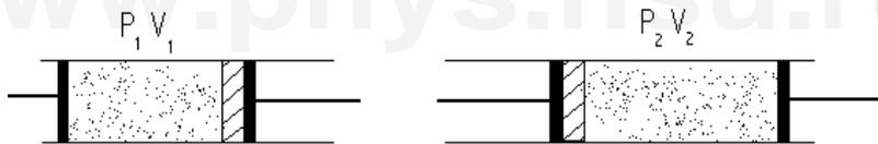
Рис. 15. «Дросселирование» газа в процесс охлаждения Джоуля–Томсона
