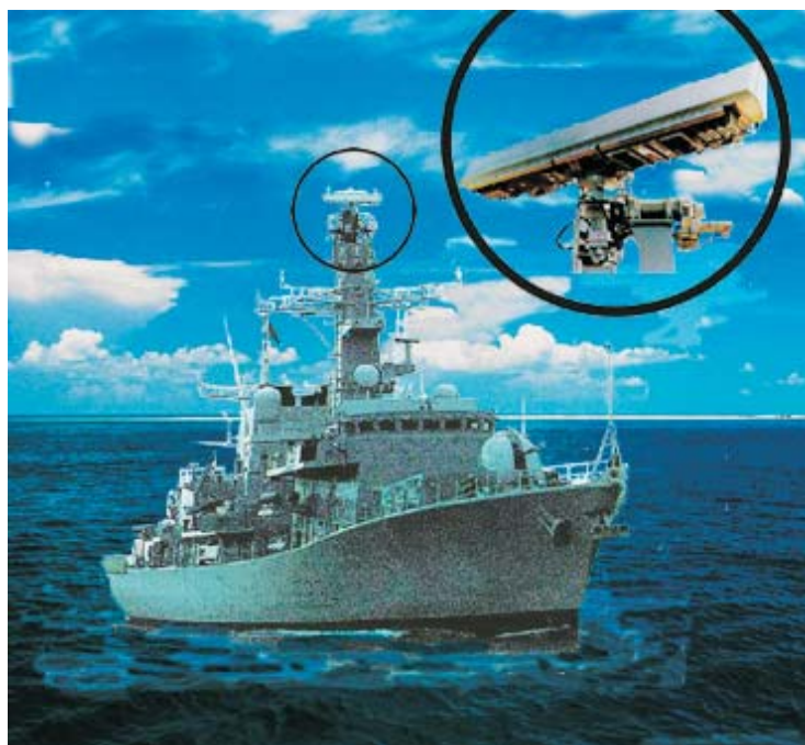
Рис.7.3.3 Многолучевая ФАР S-диапазона AWS-9 (Siemens)
