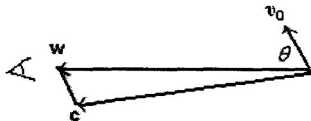
Рис. 4.1. Схема хода луча света от источника к приёмнику. c – скорость света, испущенного источником; v_0 – скорость источника света относительно детектора света; w – результирующая скорость света, направленной от источника к детектору; \theta – угол между векторами \mathbf{w} и \mathbf{v}_0 .
