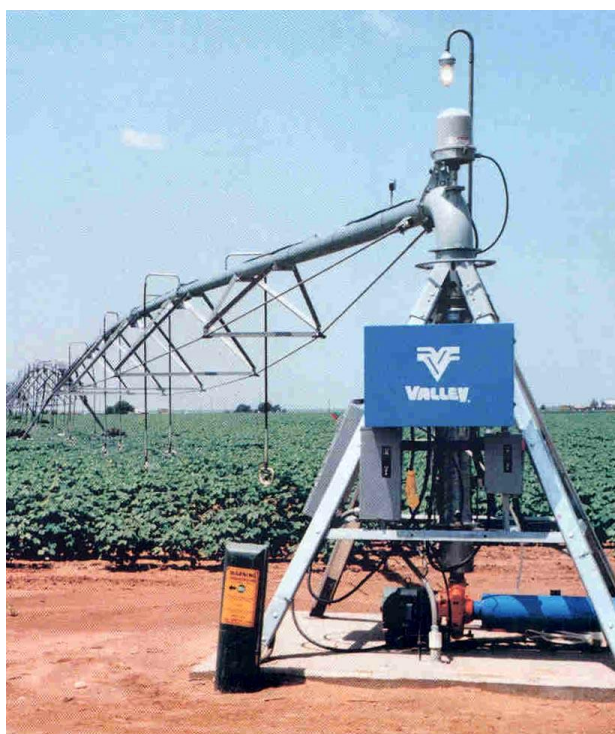
Рис. 1. Вид низконапорной дождевальной машины «Valley» со стороны центральной опоры
