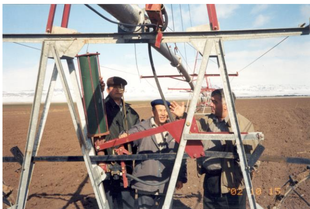
Рис. 4. Опорная тележка серийной низконапорной дождевальной машины ДМ «Фрегат-Н» с уменьшенным рабочим давлением воды с 0,60 МПа до 0,4 МПа
