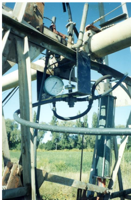
Рис. 5. Отсечной клапан, на входе предложенной системы управления работой низконапорной дождевальной машины с рабочим давлением 0,2 МПа
