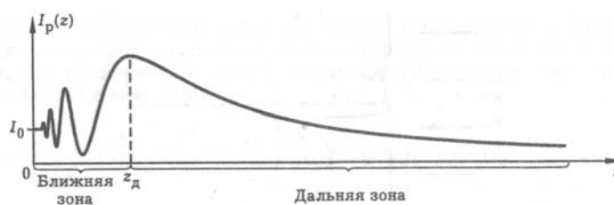
Рис. 8.8. Зависимость интенсивности света на оси отверстия от расстояния до экрана. z_d — дифракционная длина светового пучка
