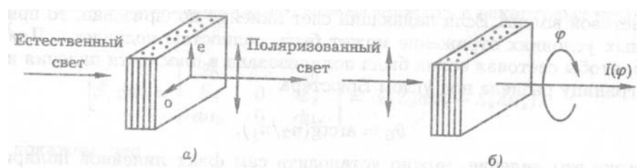
Рис. 13.4. Анизотропное поглощение. Получение (а) и анализ света с помощью кристалла турмалина
