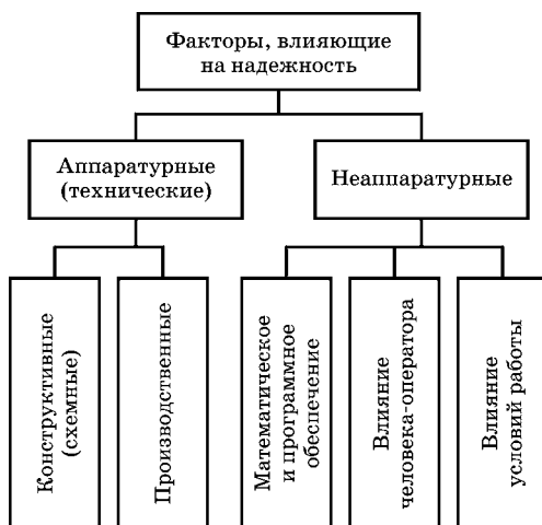
Рис. 6.2 Факторы, влияющие на надежность элементов ЭА
