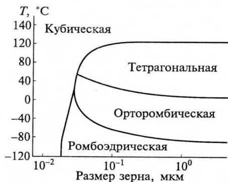
Рис. 3.8. Влияние размера зерна на температуру перехода между модификациями BaTiO_3 [68, 72]
