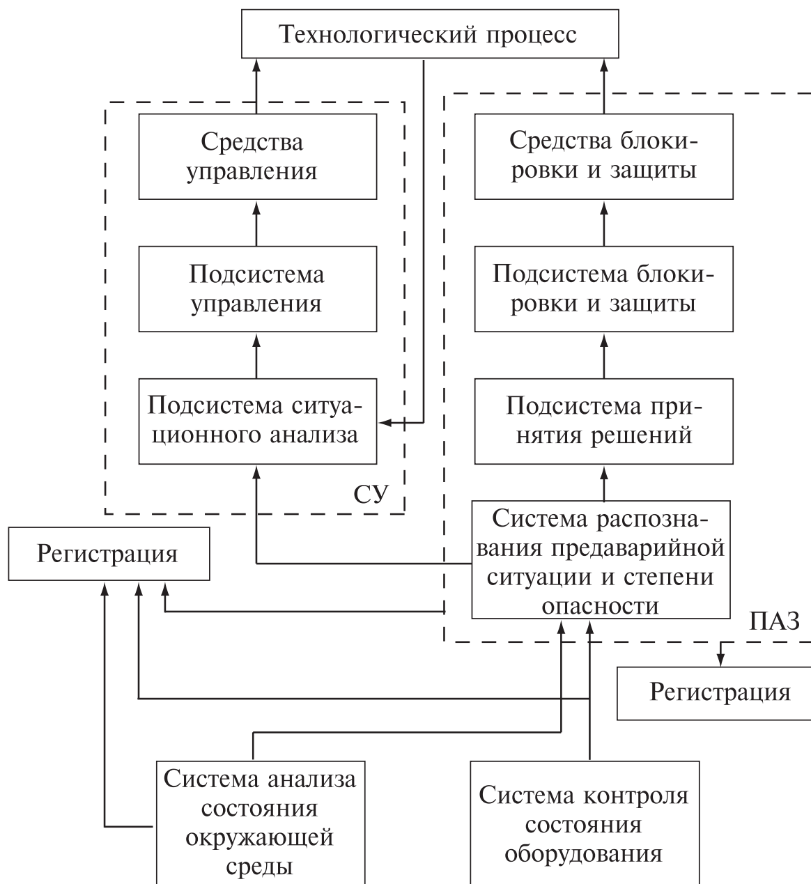
Рис. 10.5. Централизованная организация технического интеллекта химического производства
